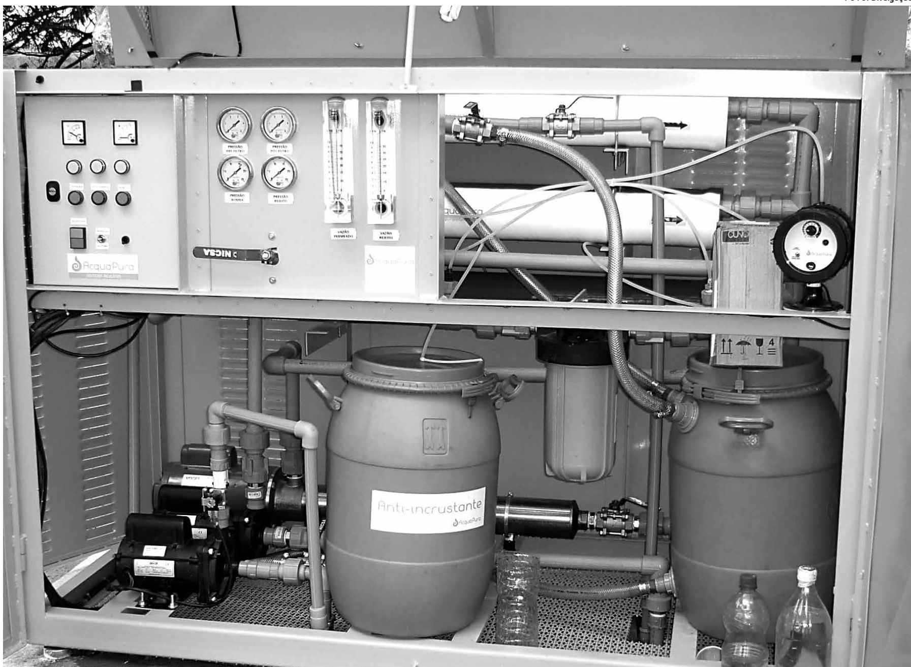
Dessalinizador torna água extraída de poços com alto teor de sal em potável e o resíduo é aproveitado para alimentar tilápia de variedade híbrida
